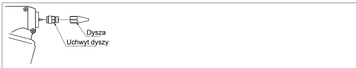
Rysunek 6/1: Wymiana dyszy (wersja do nanoszenia ściegu)
