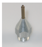
Długa dysza punktowa Ø 1,8 mm L = 32 mm Gwint: UNF 7/16
