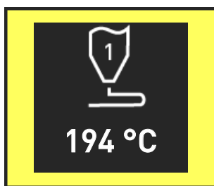
Żółty: Przekroczenie zadanej temperatury
